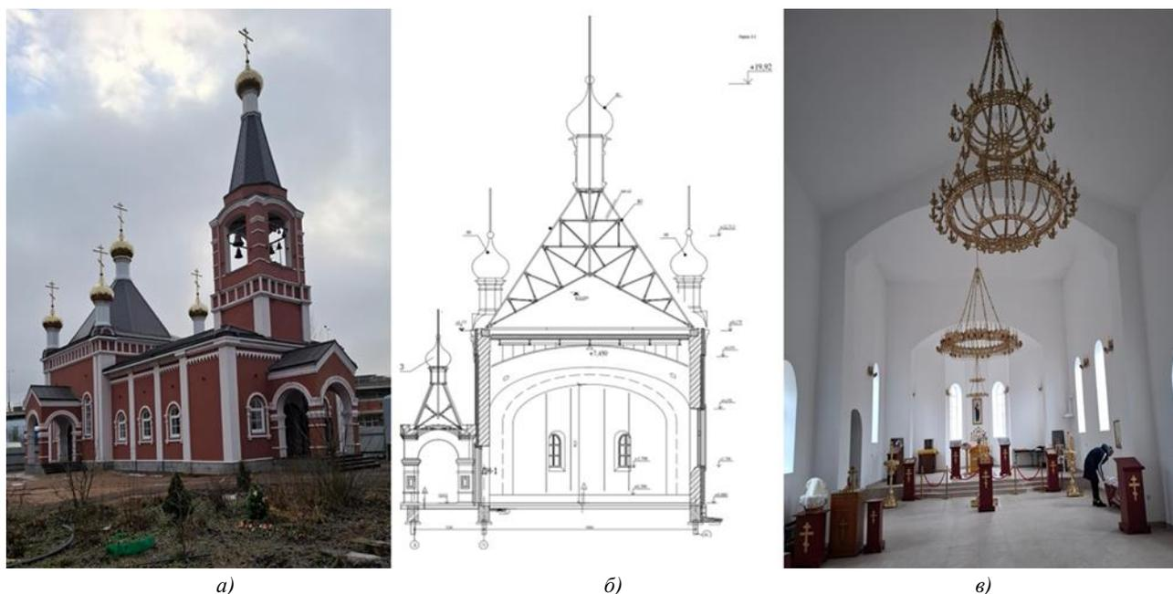
Рис. 1. Храм святителя Тихона, Патриарха Московского: а — внешний облик храма; б — разрез храма с учетом встраиваемой конструкции арочной балки; в — вид храма в сторону алтаря изнутри
