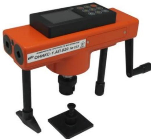
Рис. 4. Адгезиметр ОНИКС-1.АП.020
