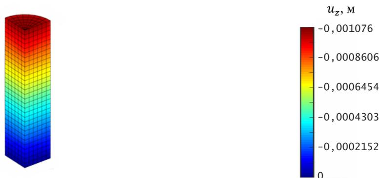
Рис. 9. Картина распределения  $u_z$  в  $1/4$  призматического образца при  $t = 60$  сут
