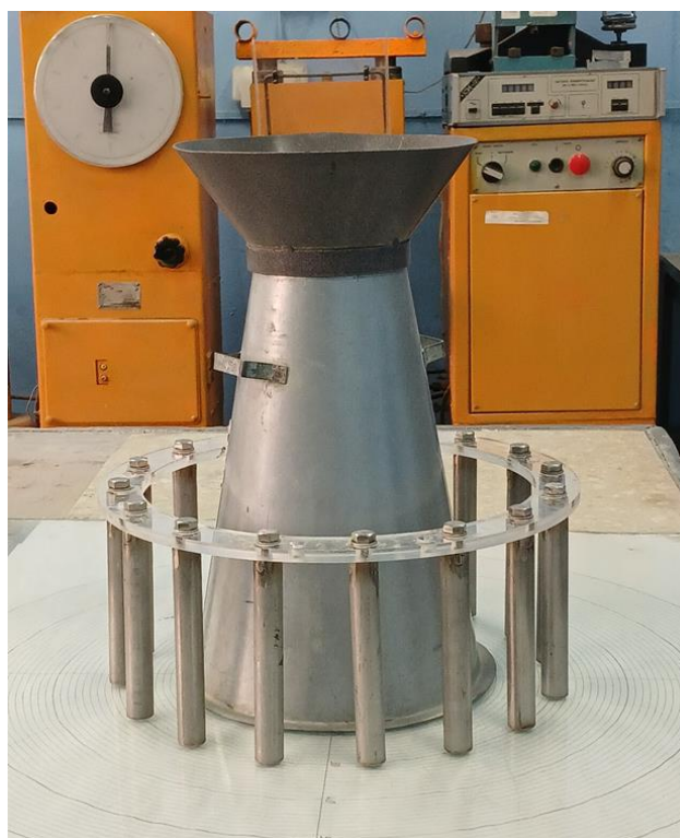
Рис. 1. Прибор для определения самоуплотняемости и текучести бетонных смесей
