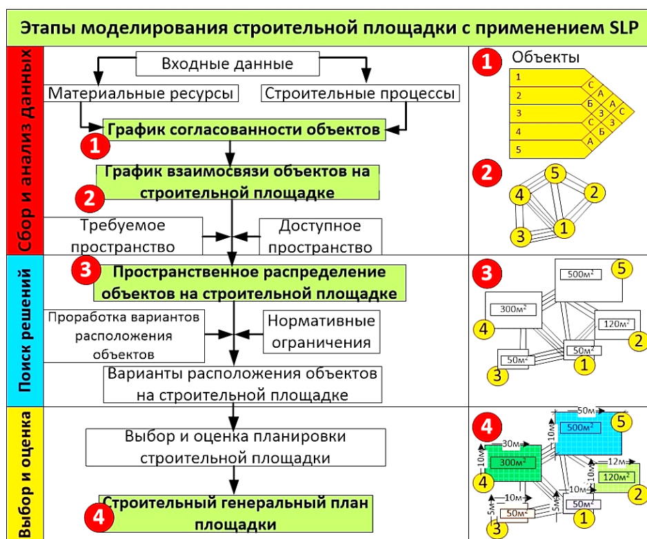
Рис. 2. Этапы моделирования строительной площадки с применением SLP
