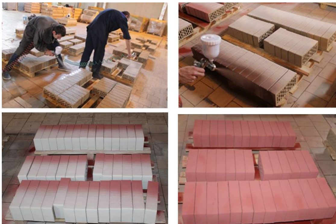
Рис. 4. Процесс ангобирования методом аэрографии в заводских условиях
