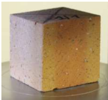
Рис. 7. Керамический кирпич в разрезе: различный цвет наружных и внутреннего слоев
