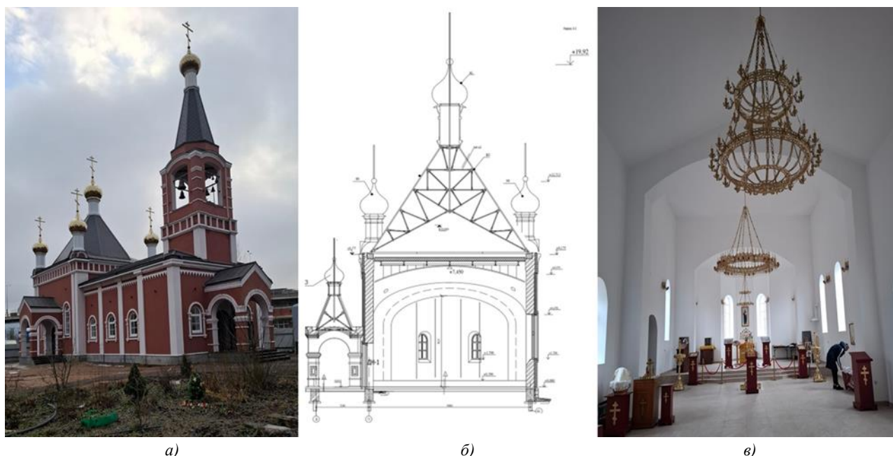
Рис. 1. Храм святителя Тихона, Патриарха Московского: а — внешний облик храма; б — разрез храма с учетом встраиваемой конструкции арочной балки; в — вид храма в сторону алтаря изнутри
