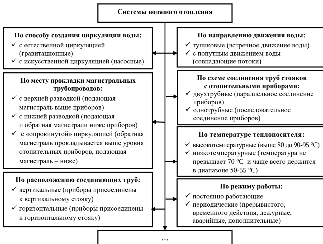
Рис. 1. Классификация систем водяного отопления
