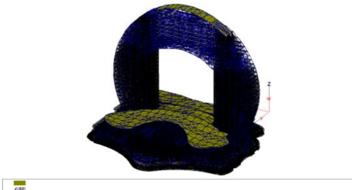
Рис. 7. Схема приложения снеговой нагрузки, \text{кН/м}^2 [15]
