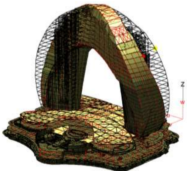
Рис. 12. Вторая форма собственных колебаний, f_2 = 0,459 Гц [15]
