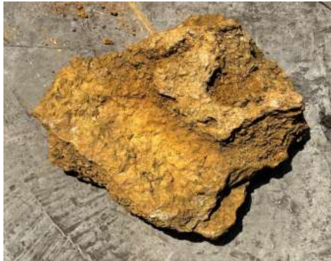
Рис. 1. Внешний вид известняка-ракушечника
