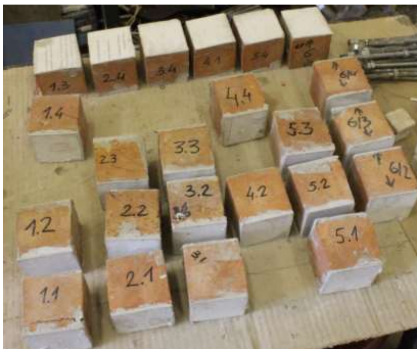
Рис. 3. Керамические образцы-кубы, подготовленные к испытаниям
